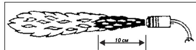
Для монтажа ТУТ (ТУМ) диаметром до 50 мм допускается применять промышленный электрофен мощностью около 2 кВт. Не рекомендуется применять для монтажа ТУТ (ТУМ) паяльную лампу, т.к. ее пламя содержит частицы масел и продуктов горения.
