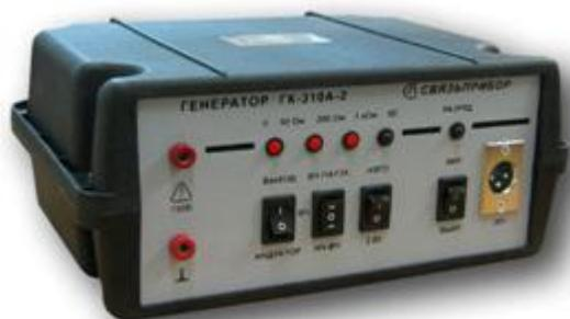
Измеритель заранее может определить наличие утечки на кабеле длиной до 2 км. Генератор ГК-310А-2 измеряет величину нагрузки. Сопротивление нагрузки менее 1 кОм, (индикатор « ∞ » не горит) свидетельствует о наличии утечки менее 1 кОм. Такая утечка уверенно определяется по всей длине кабеля.
