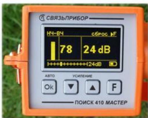
Подключив генератор к поврежденной жиле и земле, измеритель ищет утечку в направлении от места подключения генератора к концу кабеля. Если прибор "видит" утечку на кабеле, показания заметно меньше 36 дБ. Для уверенного поиска не следует обращать внимание на отклонения от 36 дБ на 2 - 4 дБ.
