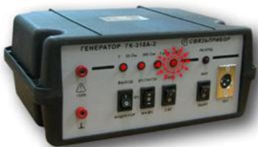
Если индикатор « ∞ » пульсирует сопротивление нагрузки более 1 кОм. Это сложный случай. Утечка с сопротивлением до 5 кОм может быть обнаружена только на дальнем конце кабеля.
