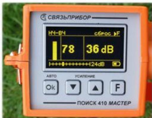
После утечки (в направлении от места подключения генератора к концу кабеля) прибор перестает «видеть» утечку и показания скачкообразно увеличиваются, становясь близкими к 36 дБ (кроме случая КЗ, когда сигнал НЧ после утечки слишком слаб). По этому признаку определяют место утечки: до утечки показания заметно меньше 36 дБ, после утечки происходит резкое увеличение показаний. Если прибор все время показывает около 36 дБ, он «не видит» утечку.
